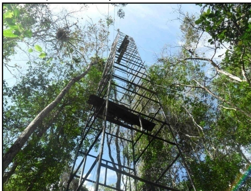
Figura 4. Torre micrometeorológica instalada no fragmento de Mata Atlântica da RPPN na fazenda Lula Lobo pertencente à usina Coruripe Açúcar e Álcool S/A, situada na cidade de Coruripe-AL (10°4'12" S e 36°17'31" W) com instrumentos de medição colocados no topo da torre.
