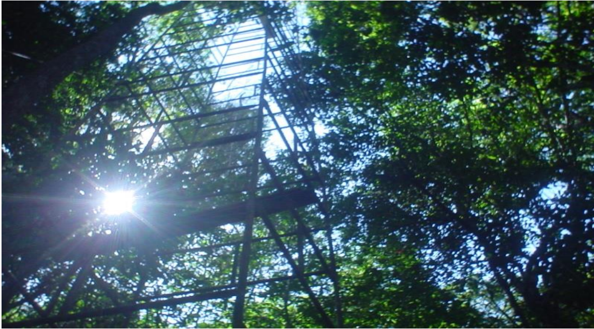
Figura 02- Vista a partir da superfície da torre micrometeorológica de 26 metros de altura instalada dentro da mata Atlântica.
