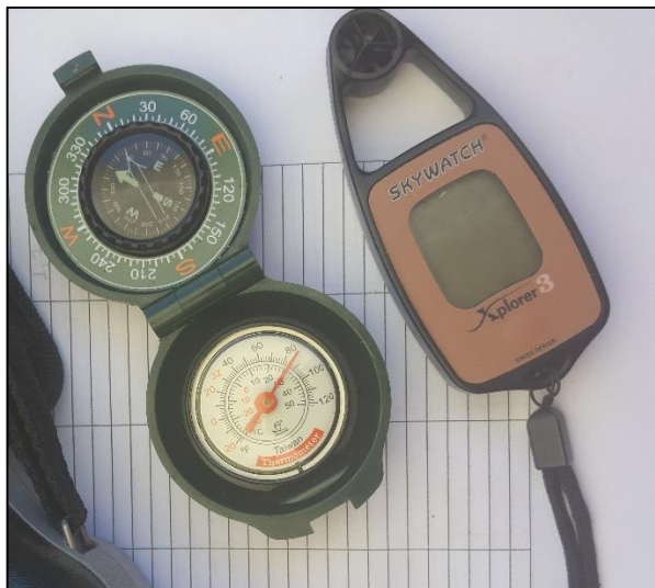
Figura 27: Anemômetro portátil acoplado a uma bússola analógica utilizado para medição da velocidade e direção dos ventos.
