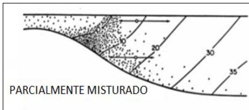
Figura 3: Diagrama esquemático de um estuário do tipo parcialmente misturado.
