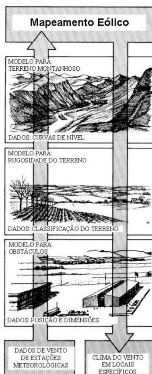
Figura 14 – Esquemática do funcionamento do WAsP.
