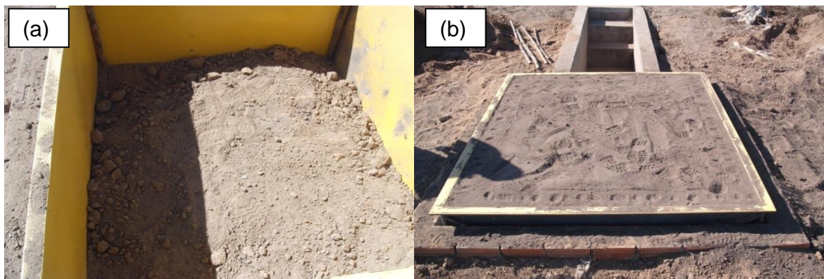
Figura 10. Preenchimento do lisímetro com solo e compactação.
