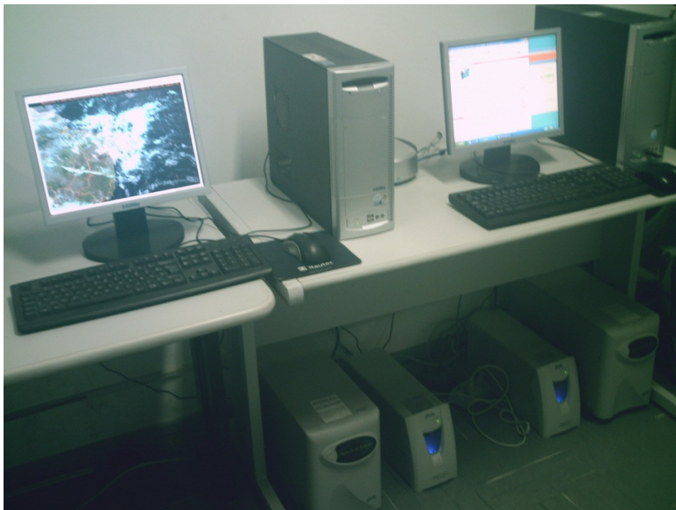
Figura 97. Modelo de estação de recepção EUMETCast empregado na UFAL, a configuração envolveu uso de computadores destinados a recepção e processamento e módulos de bateria
