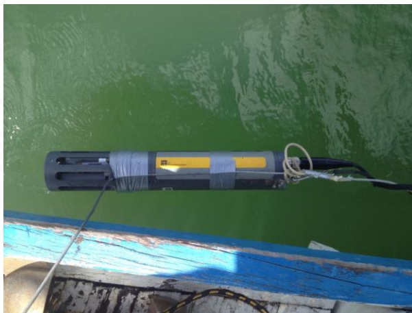
Foto 1: Sonda multiparamétrica para amostragem da salinidade e temperatura da água.
