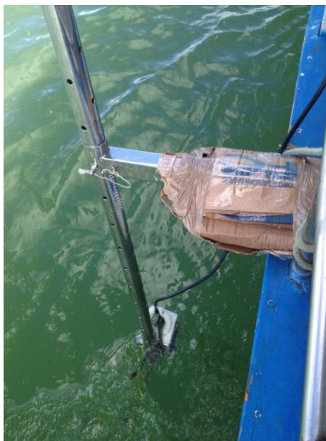
Foto 5: ADCP utilizado para medição da velocidade e direção da corrente.
